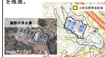
土砂災害のおそれのある範囲内に 立地する浄水場の例(広島県瀬野川流域)
