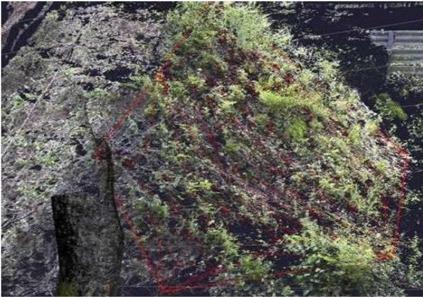
草の影響で地表面が正確に計測できない例
